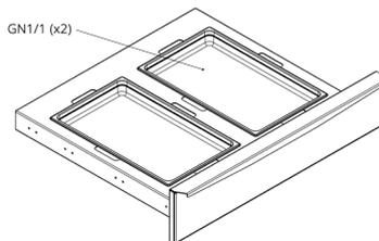
Temperaturas secundarias de los cajones entre 55°C y 90°C, basadas en el horno a 300°C.
