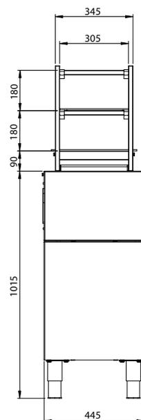
\*Altura de pata ajustable: 135-195 mm
