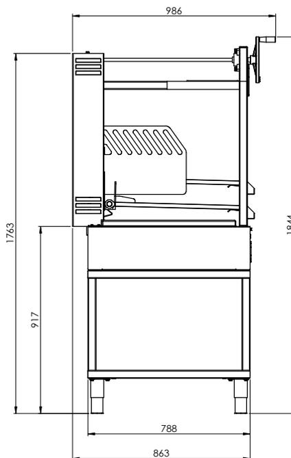
\*Altura de pata ajustable: 135-195 mm
