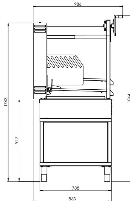
\*Altura de pata ajustable: 135-195 mm
